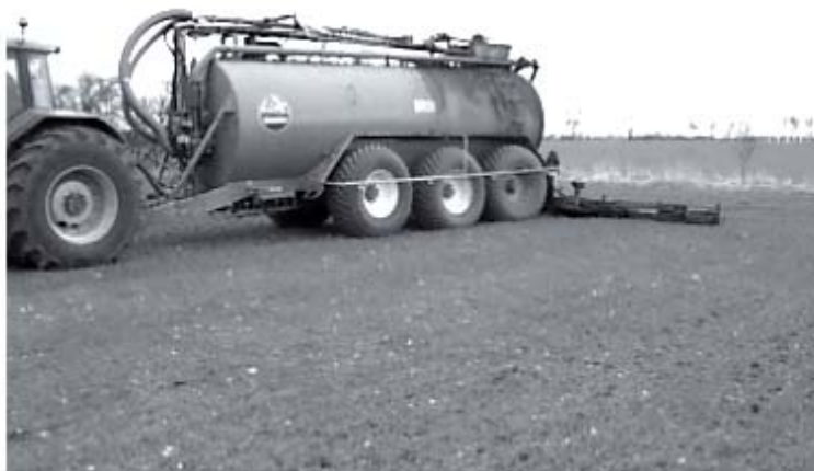
5.11. attēls. Pašuzpildoša transportcisterna ar šķidrmēsļu izkliedētāju
