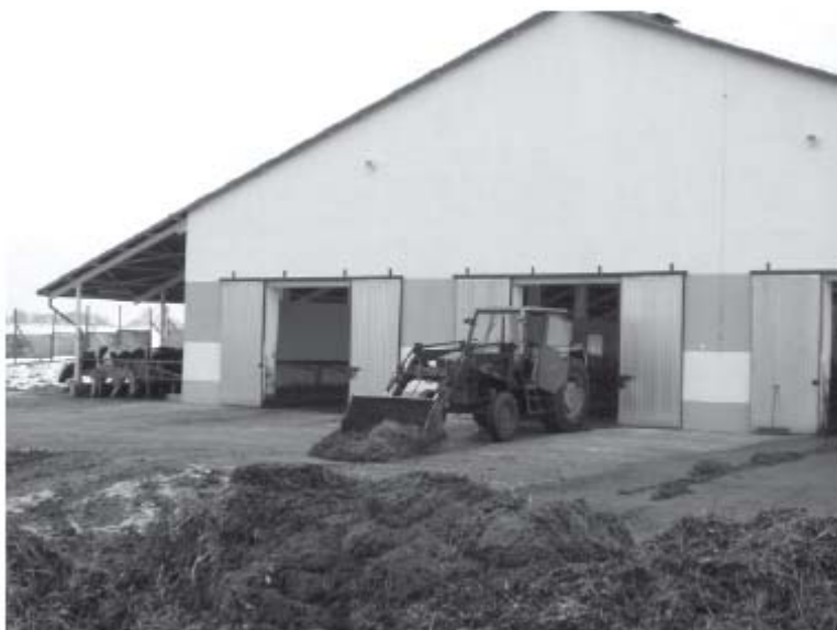
5.16. attēls. Kūtsmēsļu izvākšana no mēsļu ejām, izmantojot frontālo iekrāvēju ar kausu
