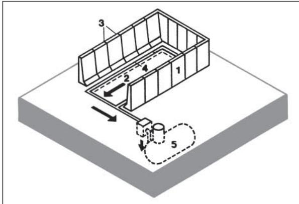
**5. attēls. Sulas savākšanas no skābbarības tranšejas shēma:** 1 – skābbarības tranšeja; 2 – krātuves grīda (betonēta vai izklāta ar asfaltbetonu); 3 – betona paneļu šuves apstrādātas ar piķi vai mastiku; 4 – tekne sulas savākšanai; 5 – rezervuārs sulas savākšanai un uzglabāšanai.
