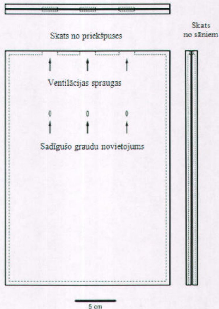
62. attēls. Divdimensiju gēla diedzēšanas kameras konstrukcijas shematiskā uzbūve
